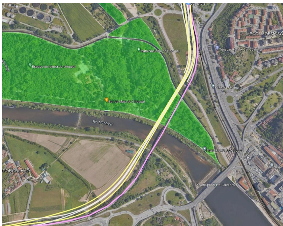
Figura 8: Quadruplicação da Linha do Norte – passagem sobre a Mata Nacional do Choupal Legenda: Quadruplicação da Linha do Norte: Linha branca - Eixo de velocidade lenta / Linha amarela – Eixo de velocidade rápida, Linha cor-de-rosa – Atual Linha do Norte, Polígono com limite branco : Mata Nacional do Choupal
